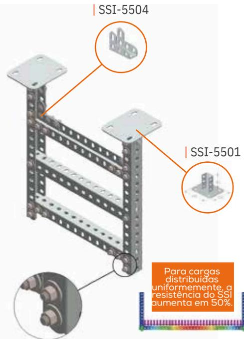
Indicação de Uso: Parafuso lenticla autotravante 3/8"x3/4"
